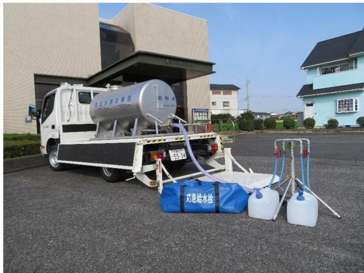
図 3-1 給水タンク、応急給水栓
